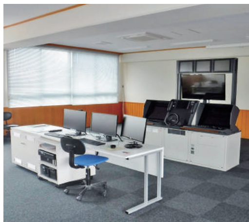
レーダー・操船シミュレーター
