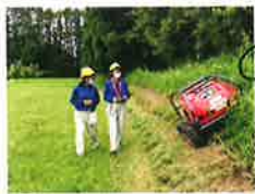
ラジコン草刈機による除草
